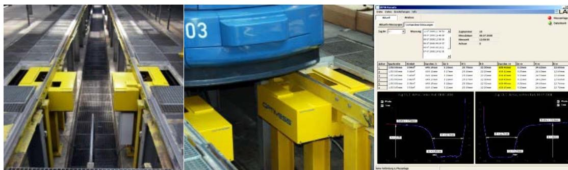
از این و شرکت Dr Wherhahn سیستم اندازه گیری درجای پروفیل چرخ را طراحی کرده است. این سیستم قابلیت اندازه گیری پروفیل چرخ و قطر آن را در میان سیر وسیله دارد. قابل ذکر است نرم افزار این سیستم علانه بر سنبش میزان نزد سایش و قطر چرخ، قادر است عمر سیر چرخ تا زمان تراشکاری بعدی پروفیل را تفمین نزد.
